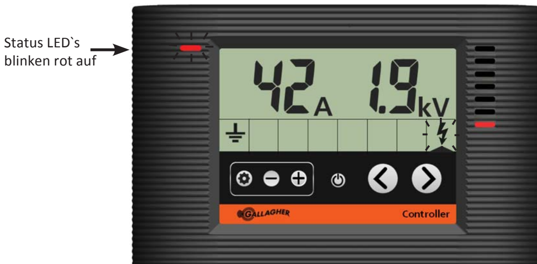
Der Display Controller des Weidezaungerätes zeigt den Stromalarm an.
