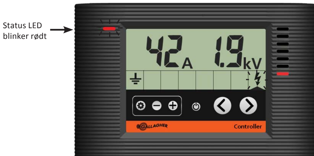
Styreenheden viser energizeren i strømstyrke alarm
