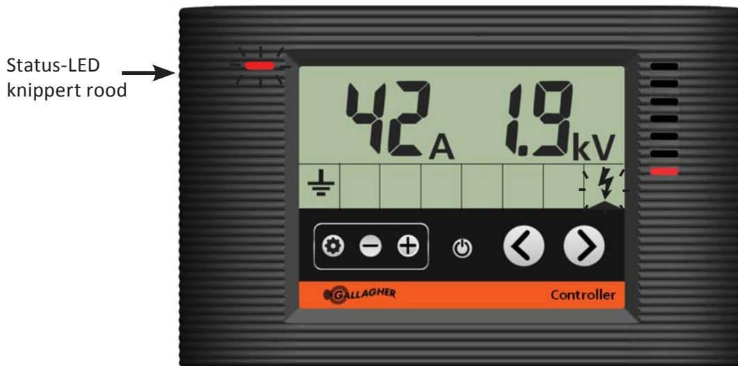
Bedieningspaneel toont het schrikdraadapparaat in stroomsterktealarm
