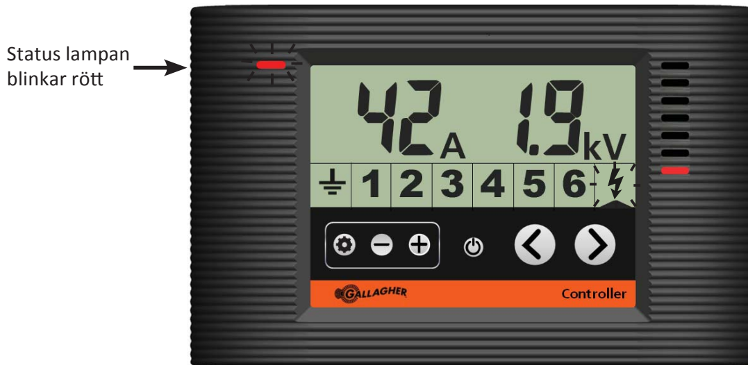
Kontrollen visar aggregat i ström larm
