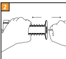
Bevestig het uiteinde van het elastisch Cord aan de schroef-isolator BS Super. En haak de poortgreep in de poortgreepanker.
