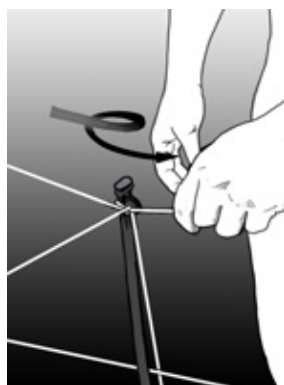
STAP 5 Draai de spanmoer (rechtsom) vast en span de draden. Bij het maken van een tijdelijke paddock, plaats de haspel paal voorbij de eindpaal en leg de topdraad om de eindpaal (5a).
