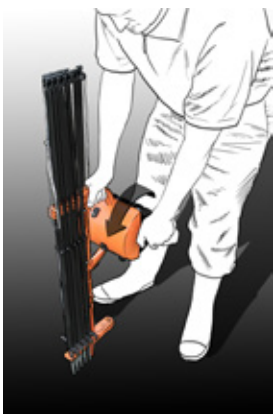
STAP 1 Draai de borgmoer open (tegen de klok in).
