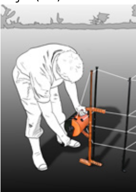
STAP 4 STAP 4a Plaats de palen naar eigen inzicht. Wanneer een hoek gemaakt moet worden, gebruik dan een scheerlijn zodat de hoekpaal recht blijft (4a)
