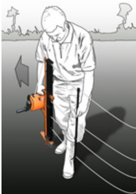
STAP 4 STAP 4a Plaats de palen naar eigen inzicht. Wanneer een hoek gemaakt moet worden, gebruik dan een scheerlijn zodat de hoekpaal recht blijft (4a)
