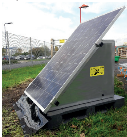
Illustration 3.1 : La bande en PVC prévient l'ombrage ultérieur du panneau solaire dû à la croissance de la végétation
