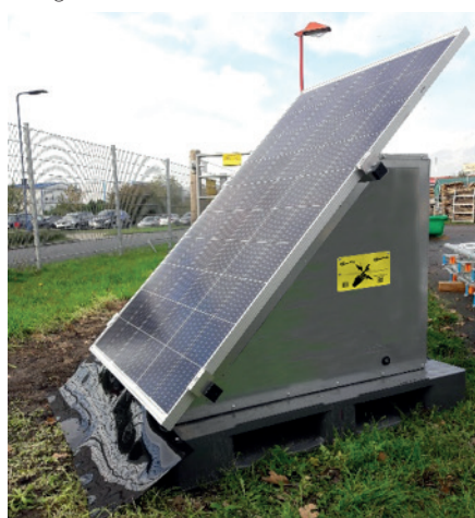
Afb. 3.1: PVC stuk bedekt de vegetatie aan de onderkant van het station zodat er geen gras tegen het paneel kan groeien.
