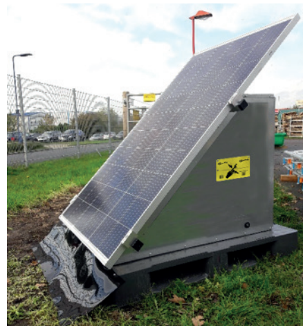
Figur 3.1: PVC Streifen schützt gegen Beschattung des Solarmodules
